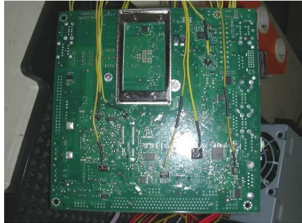
Klimatest: Temperatursensoren an relevanten Bauteilen auf der Unterseite des mini
