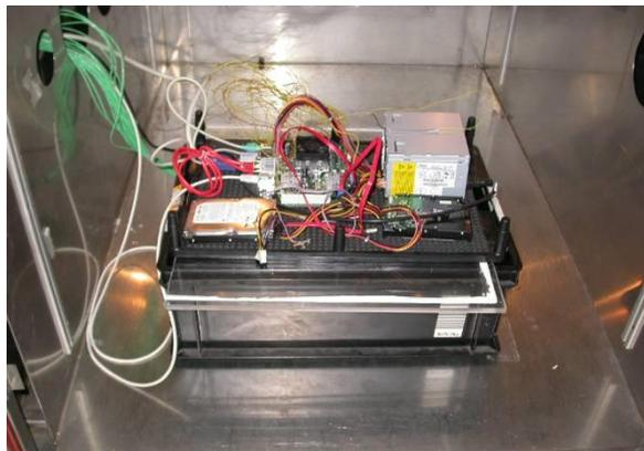
Klimatest: mini ITX Industriemainboard D2703-S beim Funktions- und Dauerstabilitätstest in der Klimakammer bei 60°C ohne Luftstrom
