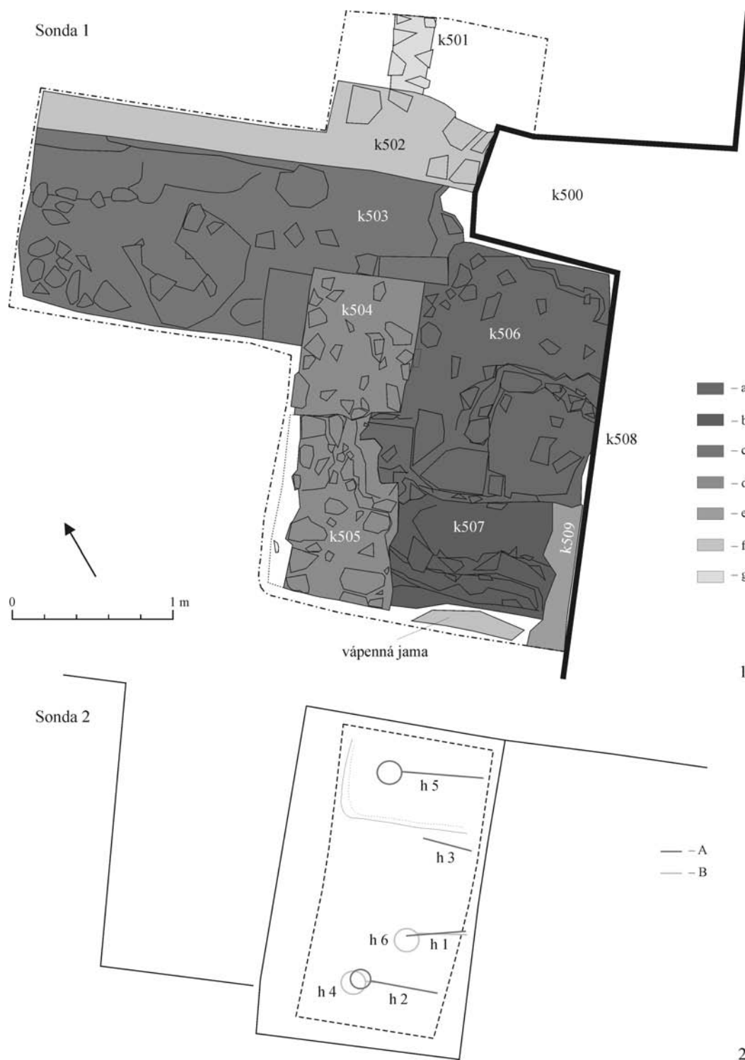
Obr. 136. Plešivec (Kostol Reformovanej kresťanskej cirkvi). 1 – zistené murivo v sonde 1. Legenda: a – nadzemné murivo k506; b – základové murivo k507; c – nadzemné murivo k503; d – základové murivo k504 a k505; e – rozšírený základ (k509) západnej steny kostola (k508); f – ohradový múr kostola (k502); g – základový múr mladšej budovy v exteriéri kostolného areálu (k501). 2 – časť preskúmaného kostolného cintorína v sonde 2. Legenda: A – preskúmané hroby; B – hroby, ktoré ležia v subpozícii s vyššie uloženými hrobmi (Poláková/Bednár, 187–190).
