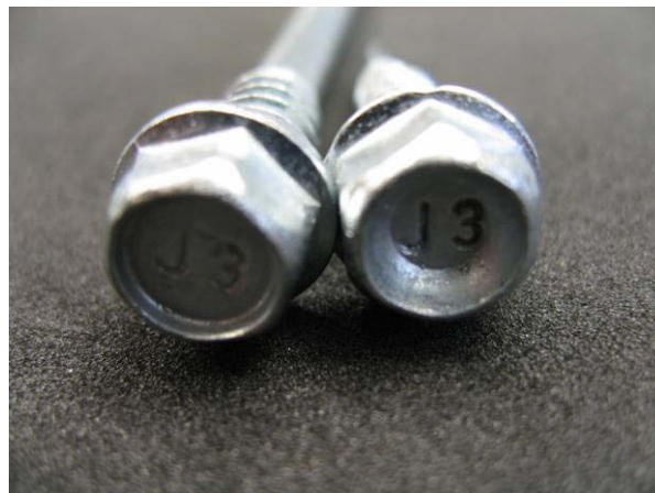
Abbildung 9: Schraubenkopf mit (rechts) und ohne (links) Kopfeinsenkung
