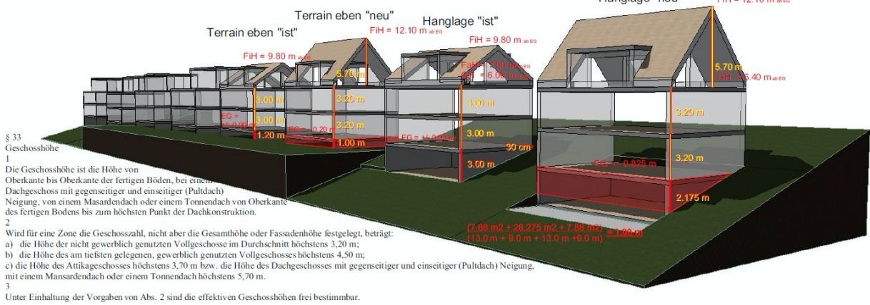
"Höhenlagen Erdgeschoss", "Geschosshöhen", "Gebäudehöhen", "Fassadenhöhen" - Analyse Stand "ist" und "neu" / Attika- und Satteldachtypus / Hang und Ebene SACHVERHALT ① "STANDARD WOHNZONE W 2"
