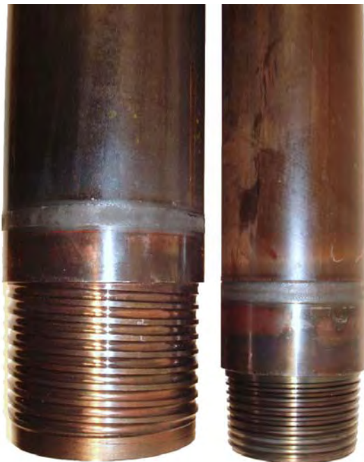
Bild oben: HM-Futterrohrkronen OD 222 mm (für Futterrohre 219 mm) und OD 160 mm mit zweiläufigem Rundgewinde links (für Futterrohre 152,4 mm)
