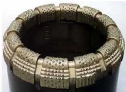
Oberflächengesetzte Diamantbohrkrone S (=Stufen)-Form mit 12 Spülungswegen u. Junkslots
