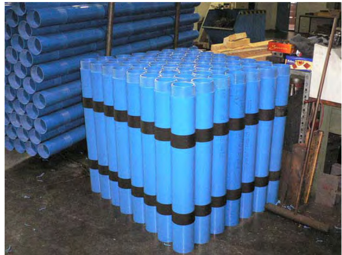
PVC-Manschettenrohre in Sonderabmessung 140 x 116 mm
