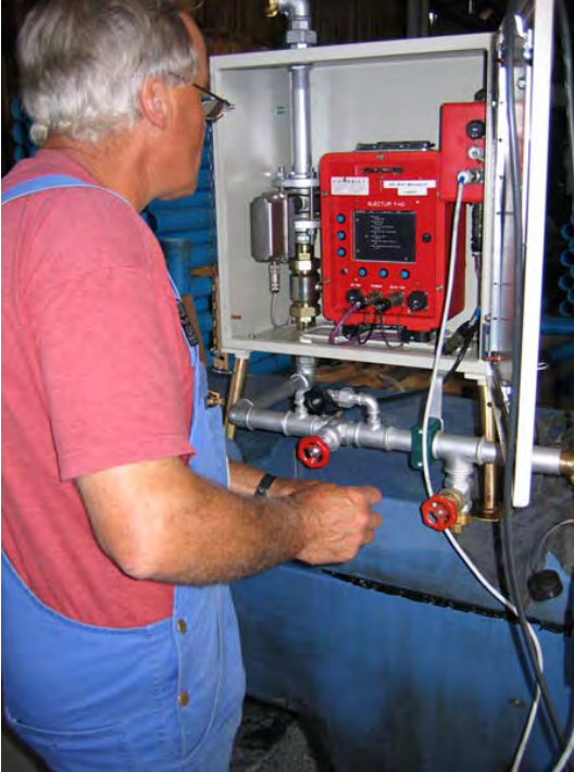
Druck-/Mengenmessgerät Injektlim 4G im Einsatz
