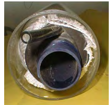
Filtergewebeschlauch NW 100 auf PVC-Rohr mit seitlicher Injektionsleitung Abdichtung mit Moosgummi
