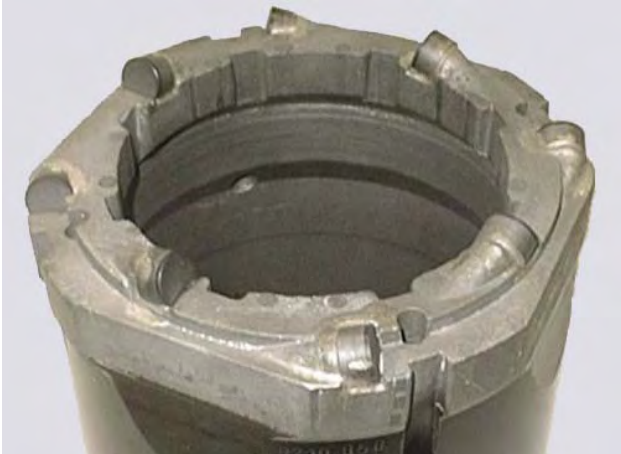
Stratacut-Bohrkrone Stufenform mit Spülungsbohrungen und breiten Junkslots
