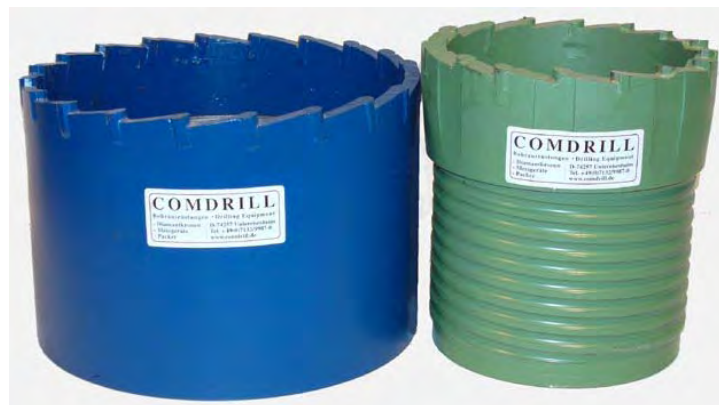
Bild oben: HM-Futterrohrkronen OD 222 mm (für Futterrohre 219 mm) und OD 160 mm mit zweiläufigem Rundgewinde links (für Futterrohre 152,4 mm)
