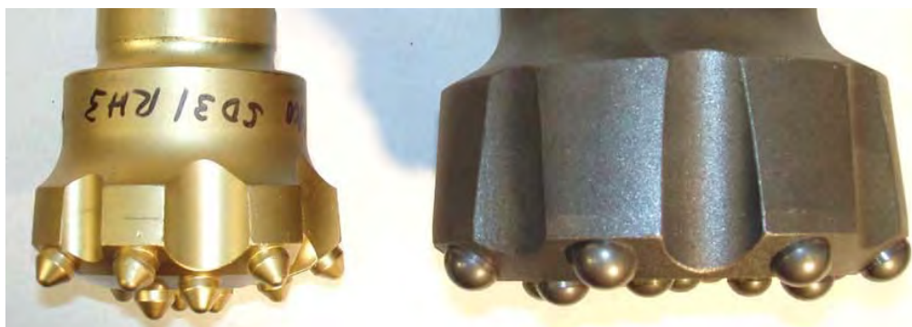
Stiftbohrkronen (Stiftbohrmeißel) links mit konischen Hartmetallstiften, rechts mit halbrunden Hartmetalleinsätzen
