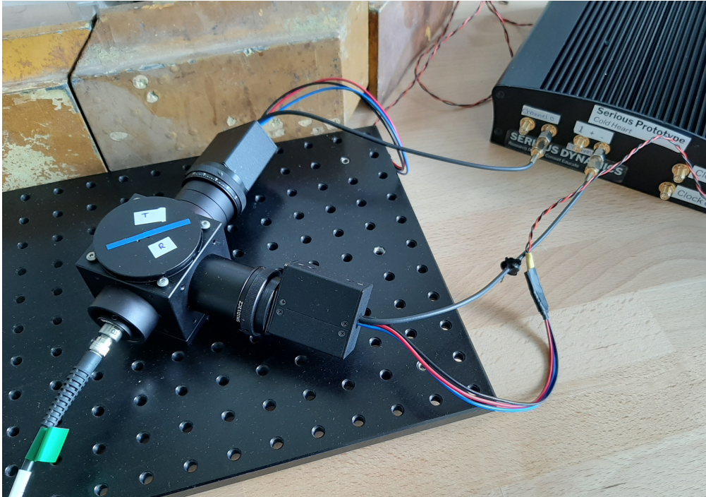
Abbildung 27: Messaufbau zur getrennten Auswertung von Photonen niedriger und hoher Wellenlänge mit integriertem Strahlteiler.
