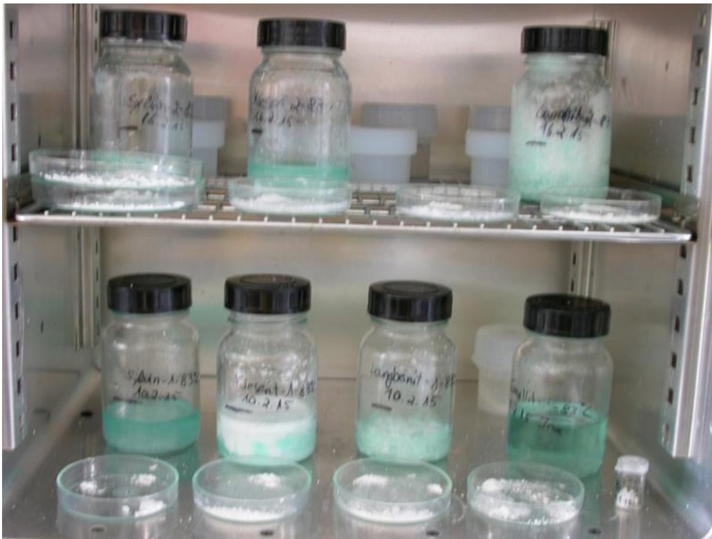
Abbildung 7 Übersichtsaufnahme in den Heizschrank der 83°C Experimente. Die Experimente zeigen unterschiedliche Stadien der Eindampfung. In den vorstehenden Petrischalen sind entnommene Kristalle zur Trocknung.
