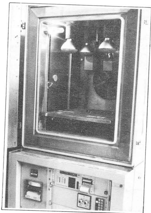
Abb. 3 : Klimaschrank bei offener Prüfkammer für mit einer Glasprobenserie auf dem Stahlrost.
