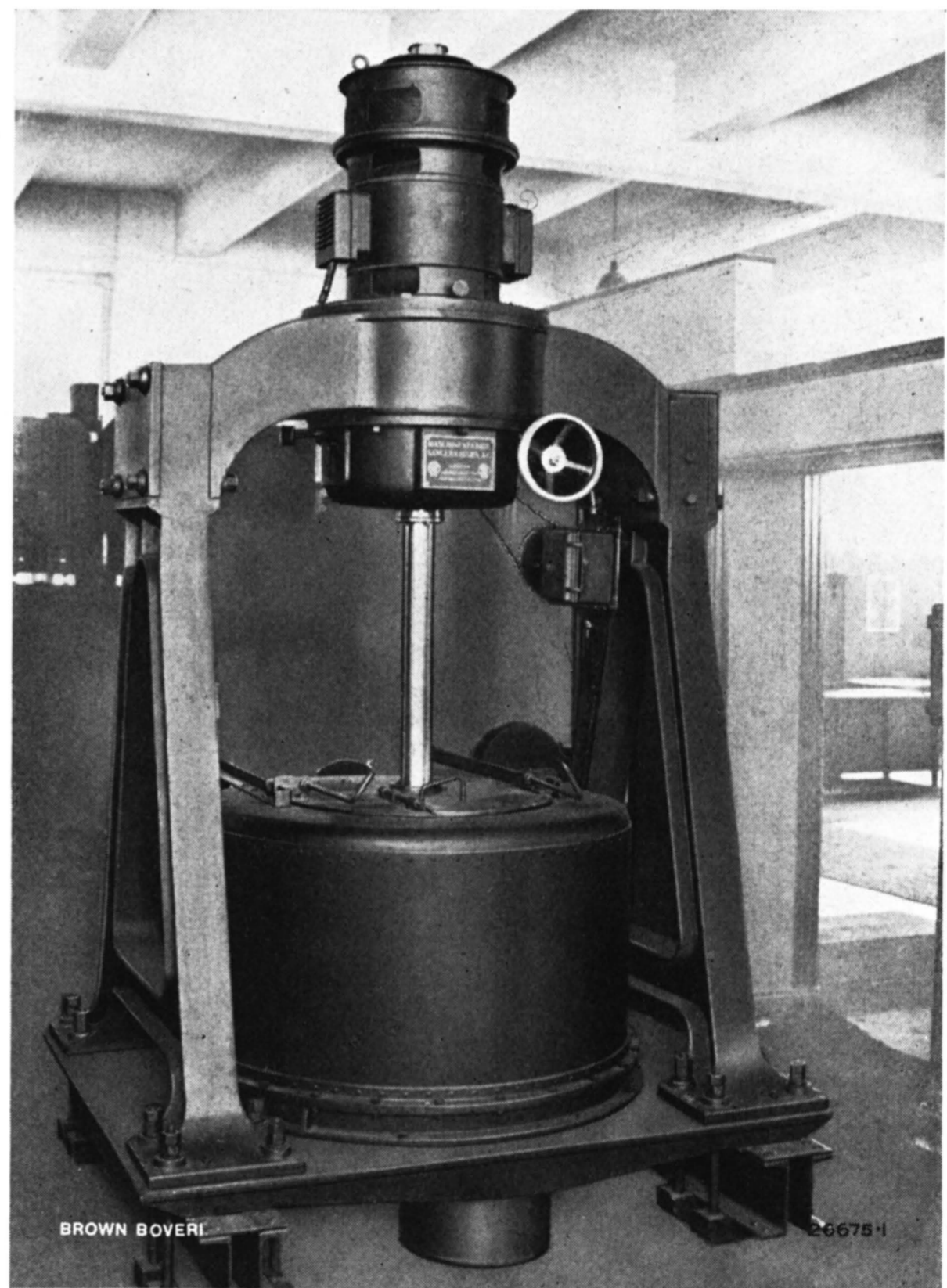
Abb. 6. — Weston-Zentrifuge mit aufgebautem, über direkt mit-nehmende Kupplung treibenden Dreiphasenmotor mit Zentrifugalanlasser.
