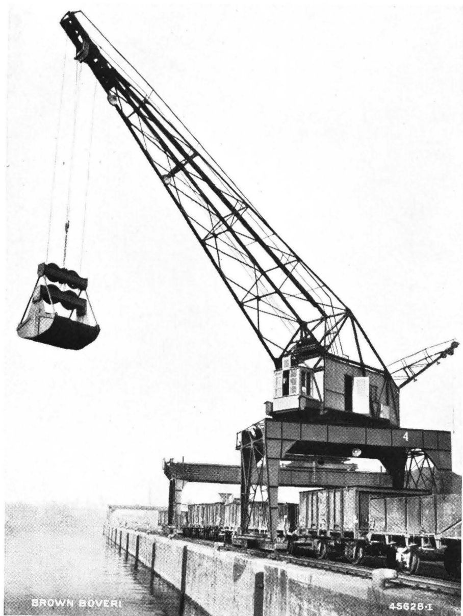
Abb. 48. — Portaldrehkran für 3 t Tragkraft. Hubwerk ausgerüstet mit der neuen über- und untersynchronen Senkbremsschaltung mit Umkehrphase.
