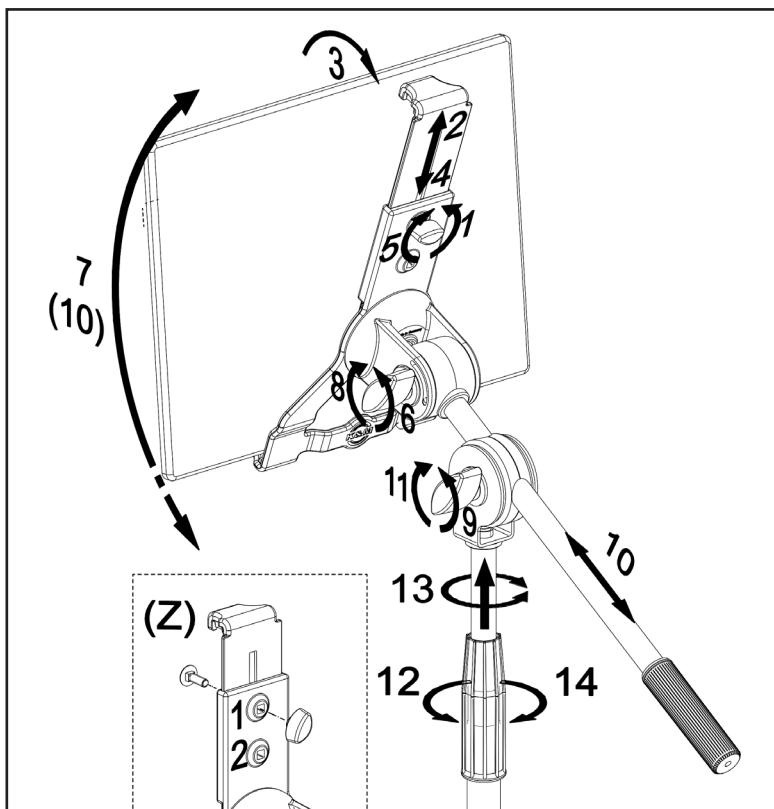
Die Klemmmutter am Schieber öffnen **1** und den Schieber nach oben ziehen **2**. Das Tablet auf die unteren Haltearme absetzen und in den Tablet-Halter ablegen **3**. Darauf achten, dass das Tablet mit der Rückseite flächig am Halter anliegt. Den Schieber auf das Tablet aufsetzen **4** und die Klemmmutter handfest anziehen **5**.
