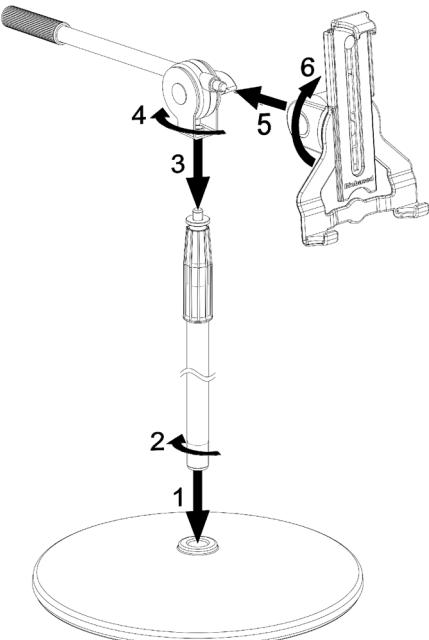
Rohrkombination auf Sockel **1** aufsetzen und vollständig in diesem verschrauben **2**.
