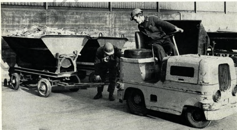
Oben: Stein stapler mit zwei Hängern Mitte: Elektrokarren mit Knüppelsteuerung Unten: Schlepper mit Kipploren-Anhänger
