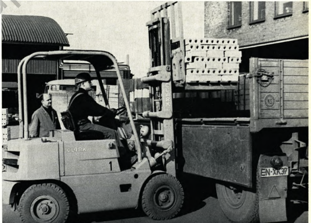
U n t e n : Stein stapler bei der Entladung eines Lastkraftwagens
