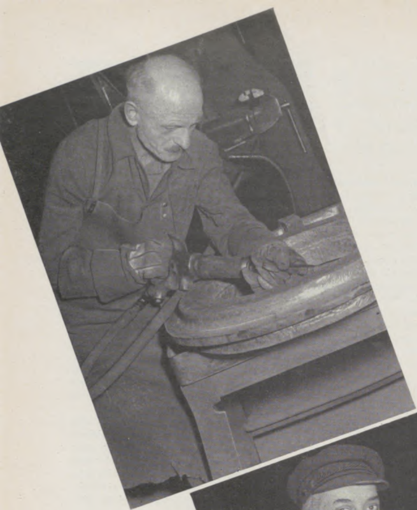
Wilhelm Kriebel Fertigputzer in der Chromgußputzerei Stachelhausen säubert mit dem Preßlufthammer die Chromgußteile von anhaftendem Sand und Graten.
