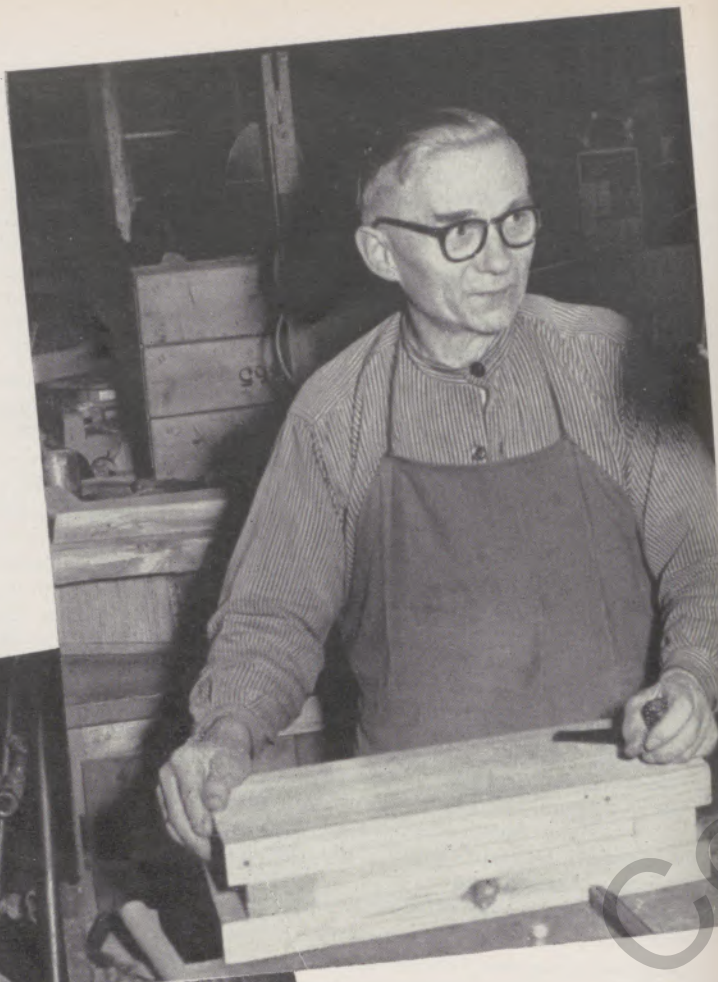
Paul Klein Modellschreiner in der Modellschrei- nerei Stachel- hausen, hat hier einen Kernkasten fertiggestellt, der noch verputzt und gestrichen werden muß.
