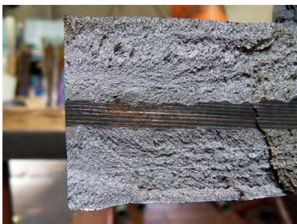
Bild B-40 Bruchflächen / Bruchbild der Stumpfstoßprobe DHY-N4
