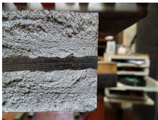
Bild B-40 Bruchflächen / Bruchbild der Stumpfstoßprobe DHY-N4
