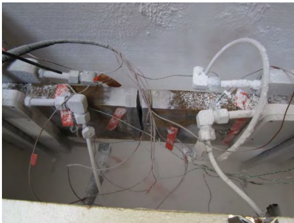
Bild B-39 Stumpfstoß DHY-N4 im Versuchsstand, vor und nach dem Zugversuch
