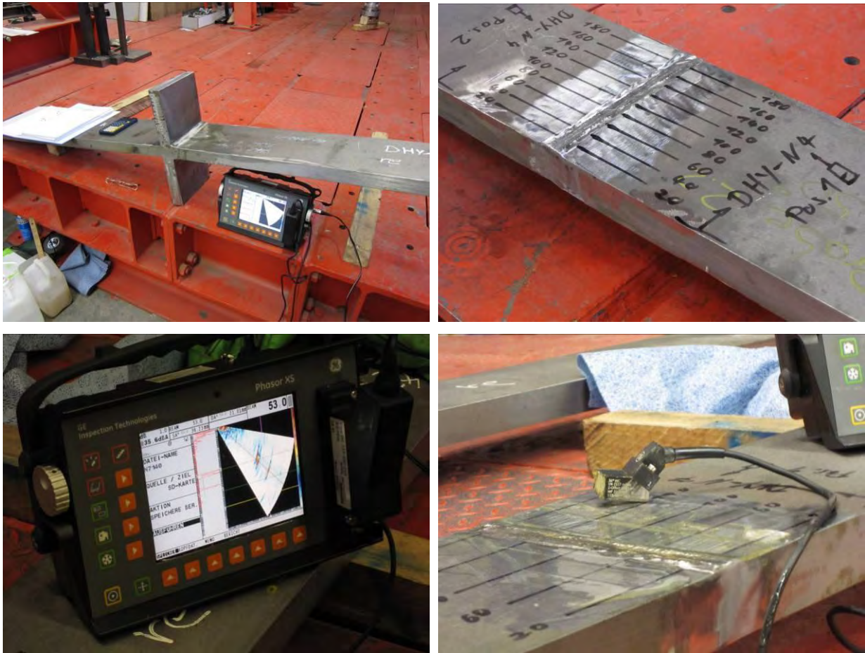
Bild 6-10 UT-Messung durch die SLV Duisburg
