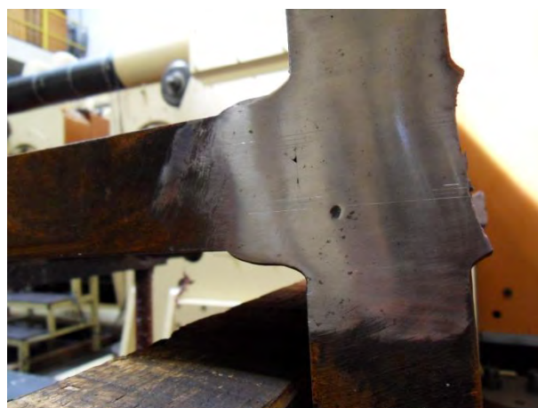
Bild B-31 Bruchflächen / Bruchbild der Kreuzprobe DHY-N2
