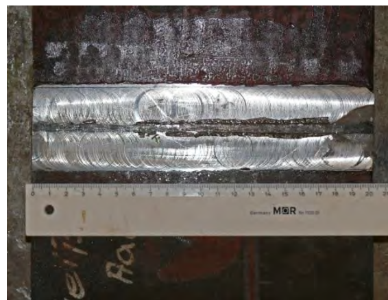
Bild E-4 Vergleich der mit UT und der aus der Bruchfläche ermittelten Restspaltgröße an der Probe DHY-N1-2
