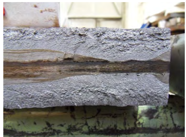
Bild B-43 Bruchflächen / Bruchbild der Stumpfstoßprobe DHY-N4-2
