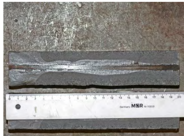
Bild E-19 Vergleich der mit UT und der aus der Bruchfläche ermittelten Restspaltgröße an der Probe DHY-N6-2
