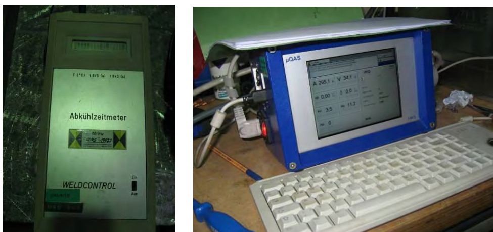
Bild 3-3 Messeinrichtung zur Messung der t_{8/5} -Zeiten
