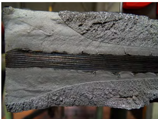
Bild B-47 Bruchflächen / Bruchbild der Stumpfstoßprobe DHY-N5
