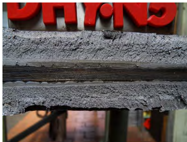
Bild B-47 Bruchflächen / Bruchbild der Stumpfstoßprobe DHY-N5
