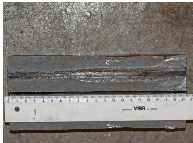
Bild E-13 Vergleich der mit UT und der aus der Bruchfläche ermittelten Restspaltgröße an der Probe DHY-N4-2
