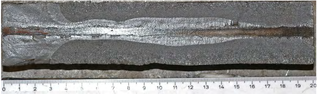
Bild E-25 Bruchfläche der Probe DHY-N6-2
