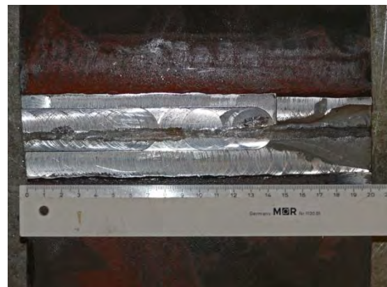
Bild E-7 Vergleich der mit UT und der aus der Bruchfläche ermittelten Restspaltgröße an der Probe DHY-N2-2
