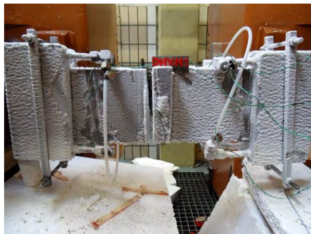
Bild B-22 Kreuzprobe DHY-N1 im Versuchsstand, vor und nach dem Zugversuch
