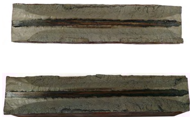
Bild E-15 Vergleich der mit UT und der aus der Bruchfläche ermittelten Restspaltgröße an der Probe DHY-N5
