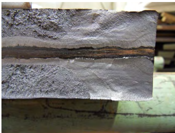
Bild B-43 Bruchflächen / Bruchbild der Stumpfstoßprobe DHY-N4-2
