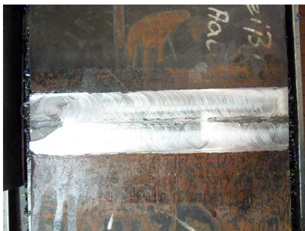
Bild B-28 Aufgefräste Bruchflächen der Kreuzprobe DHY-N1-2
