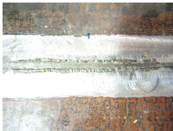
Bild B-28 Aufgefräste Bruchflächen der Kreuzprobe DHY-N1-2
