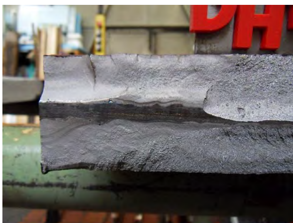
Bild B-35 Bruchflächen der Kreuzprobe DHY-N2-2
