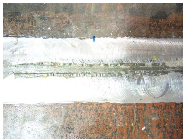
Bild B-36 Aufgefräste Bruchflächen der Kreuzprobe DHY-N2-2
