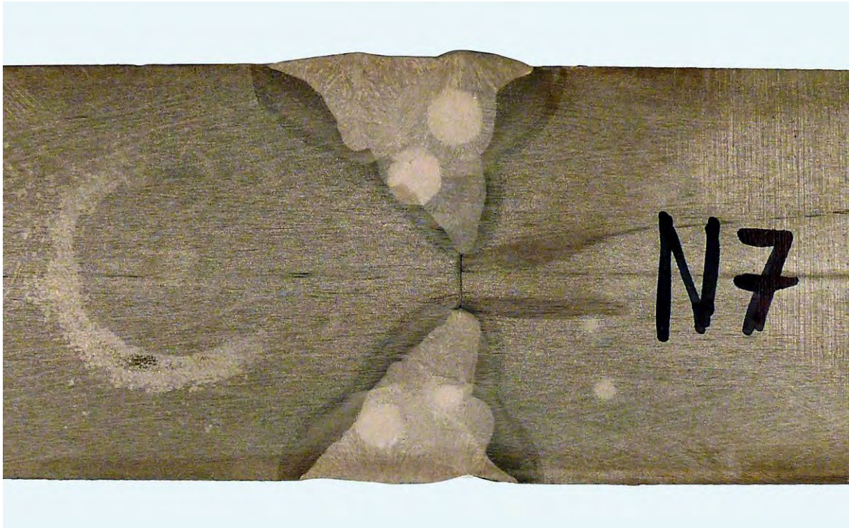
Bild B-14 Probe DHY-N7 – Makroschliff an Stumpfstoßverbindung mit Öffnungswinkel 42°
