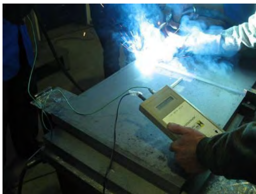
Bild 3-5 Versuchsdurchführung, t_{8/5} -Zeit Messung
