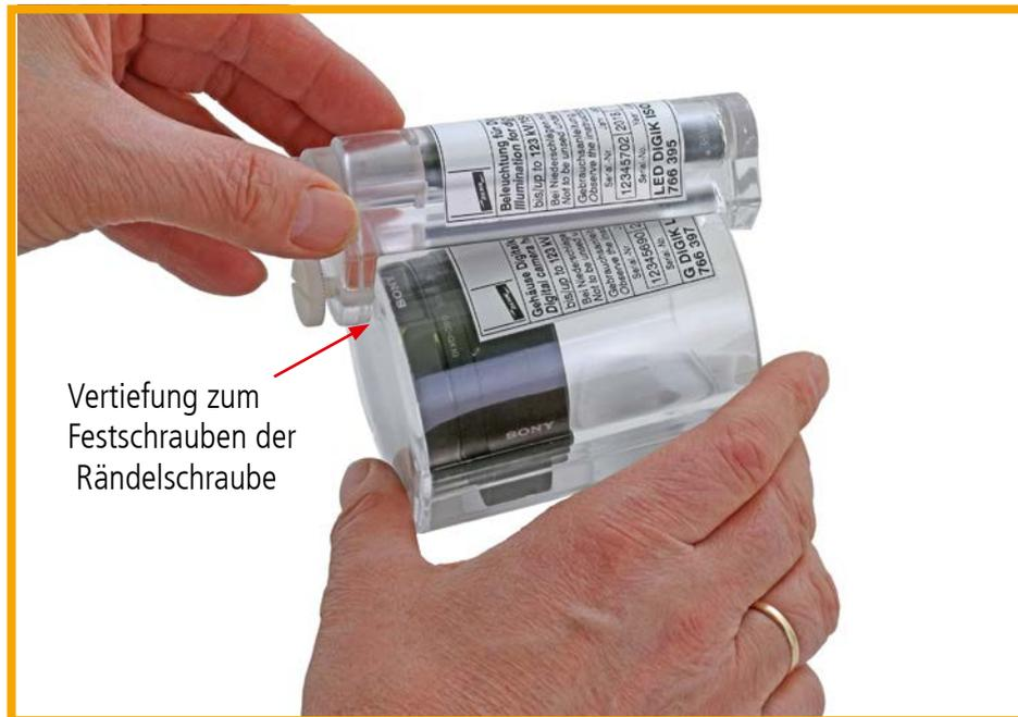
**Bild 5** LED-Gehäuse auf das Kameragehäuse aufsetzen
