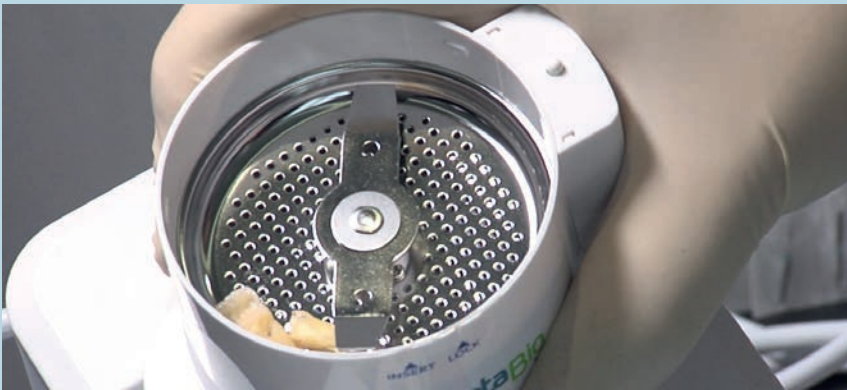
Abb. 4 In der Mahlkammer des Smart Grinders lassen sich einer oder mehrere extrahierte Zähne innerhalb von nur drei Sekunden partikulieren.
