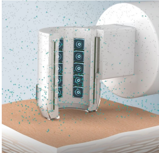
Abb. 1: Schnitt durch eine Open-Chamber-Sonde (vergrößert) (Tewameter; Werksfoto: Courage & Khazaka, Köln)
