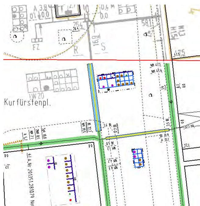
Abb. 43: Gegenüberstellung von Mehrstrich und Trassendarstellung (Sparte STROM)*)
