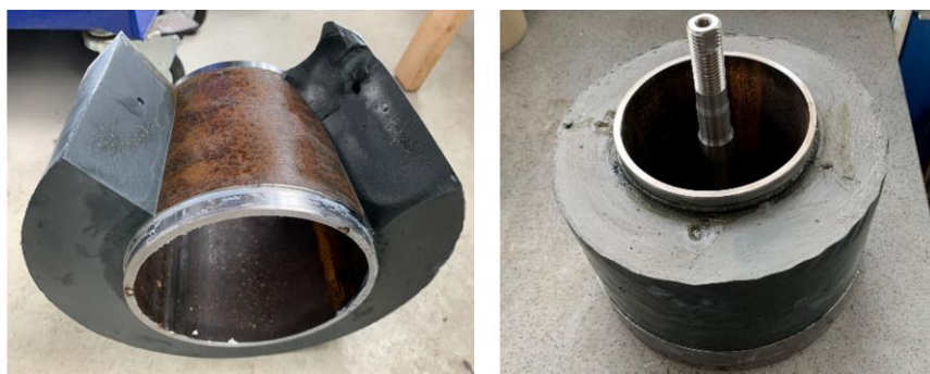
Abbildung 2: Hohlzylinder-Verbundprobe aus Futterrohr und Zement
