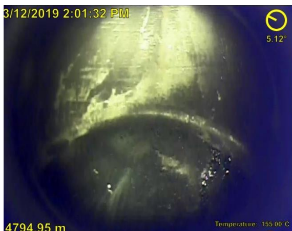
Abbildung 6: 3 1/2" Tubing-Shoe Kante (Side - View) vor Druckerhöhung
