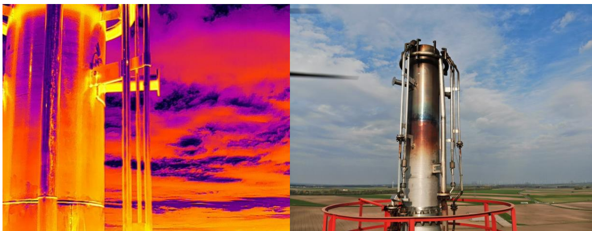
Abbildung 6: Aufnahme einer Fackel mit einer FLIR-Kamera, daneben zum Vergleich die Fackel in Normalaufnahme (beispielhaft, nicht von Taurob aufgenommen).
