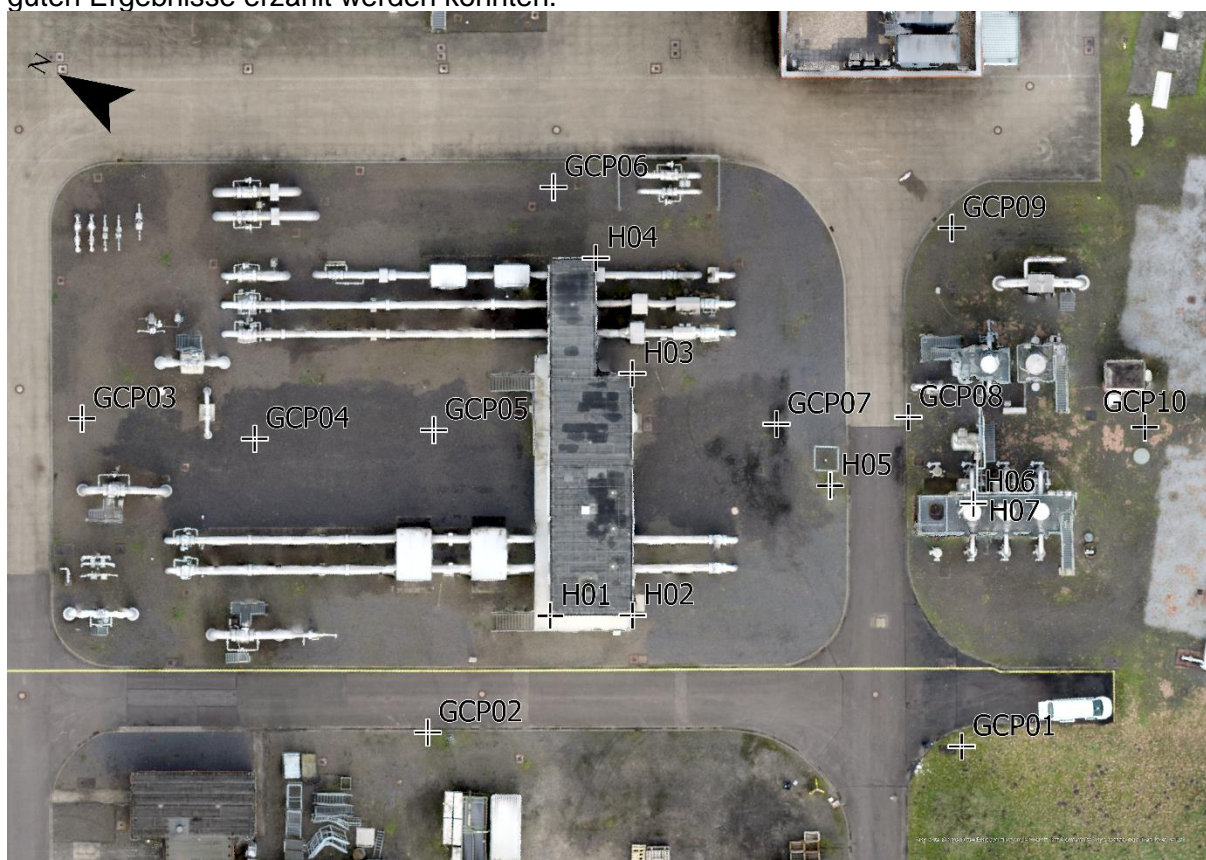
Abbildung 3: Genauigkeit eines erstellten Orthofotos im Vergleich mit terrestrisch vermessenen GCP und Höhenpunkten (Dachkanten)
