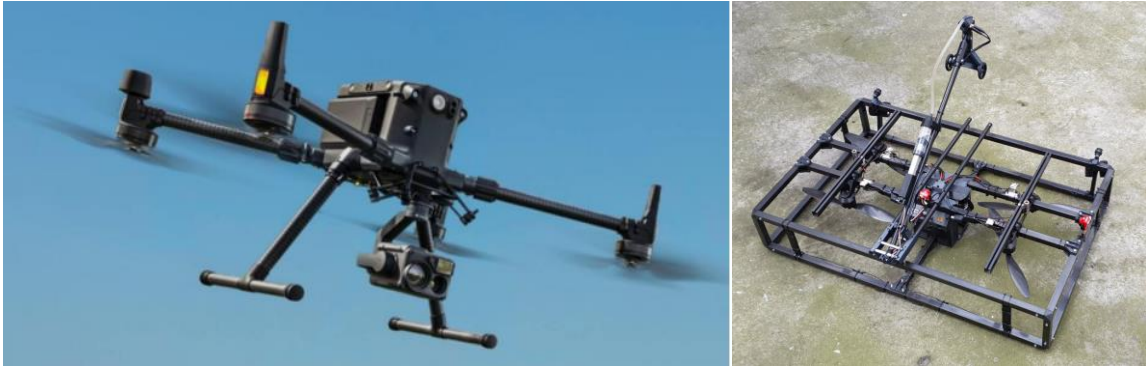
Abbildung 2: Kameradrohne und Tankinspektionsdrohne
