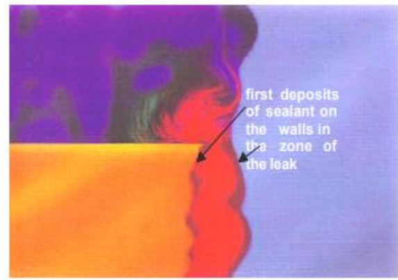
Abbildung 2: Die ersten Ablagerungen des Abdichtmittels an der Undichtigkeitsstelle (3)
