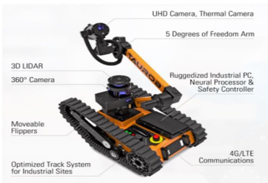
Abbildung 5: Taurob autonomer Roboter
