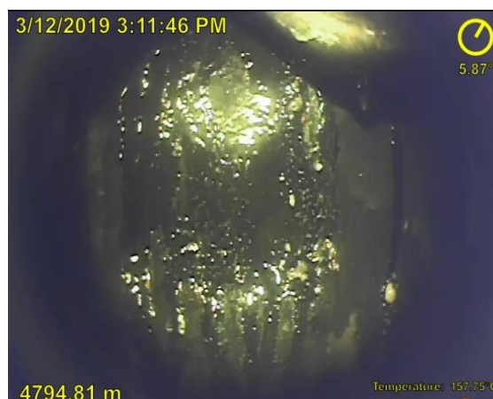
Abbildung 7: 3 1/2" Tubing-Shoe Kante (Side - View) nach Druckerhöhung
