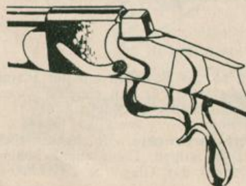
Aydt-Block-Verschuß mit Schlingenbügel.
