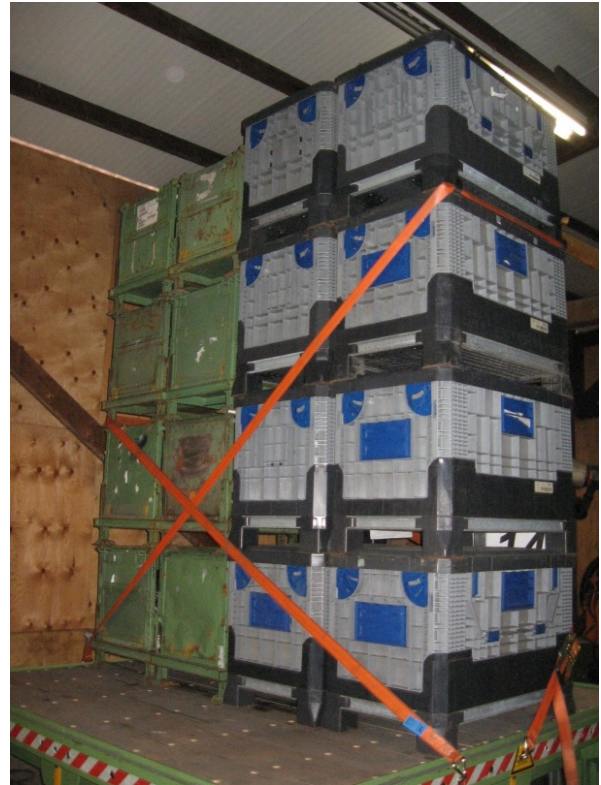
Abb. 13 Seitliche Diagonalverzurrung der LT 2671 über Füße der 4. Ebene
