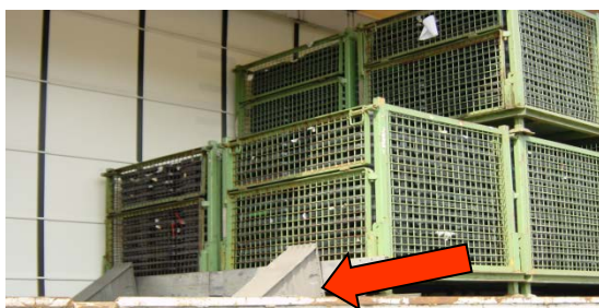
Abb. 34 Unterbrochene Ladung mit Sperrbalken
