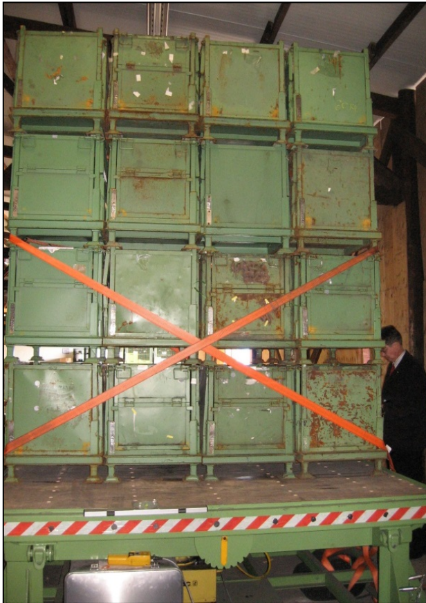
Abb. 31 Seitliche Diagonalverzurrung der LT 2071 über Füße der 3. Ebene
