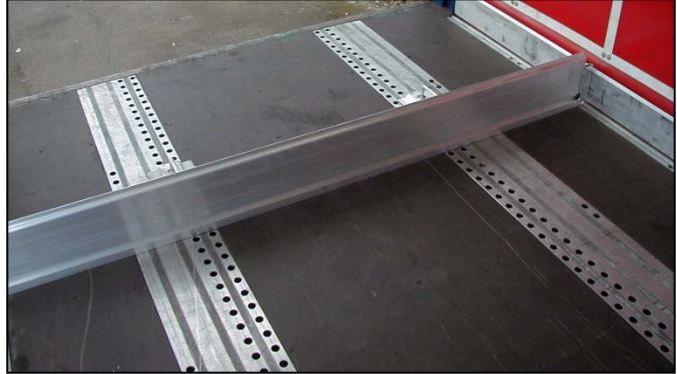
Abb. 22 Anordnung Lochschiene und Sperrbalken
