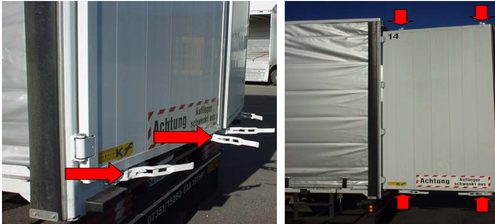
Abb. 5 Hecktüren mit 2 Paar Drehstangenverschlüssen
