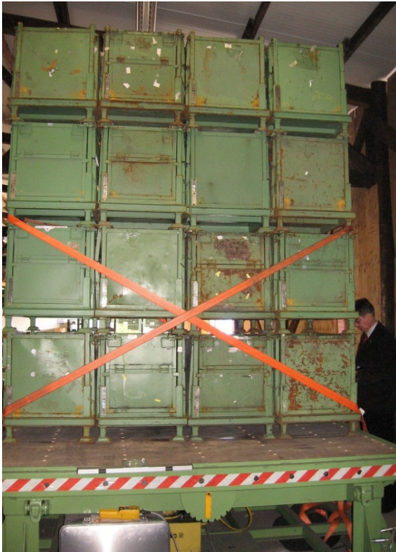
Abb. 12 Seitliche Diagonalverzurrung der LT 2071 über Füße der 3. Ebene
