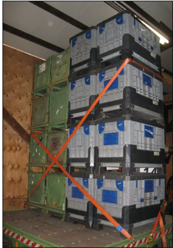
Abb. 30 Seitliche Diagonalverzurrung der LT 2671 über Füße der 4. Ebene
