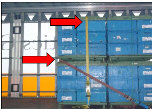
Abb. 32 Niederhaltezurrung letzte Stapel-Ebene und Diagonalzurren
