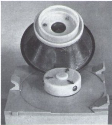
Abb. 32: Fliehkraftkupplung eines Entsafters. Die Fliehkraft preßt die Metallstifte (Pfeile) gegen den glatten Innenrand des Arbeitsteils
