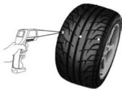
Fig. 8. Misurazione della temperatura dei pneumatici
