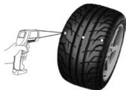
Ilustración 8: Medición de la temperatura de las llantas
