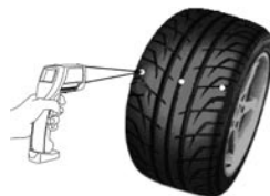
Fig. 8 : Mesure des températures des pneus
