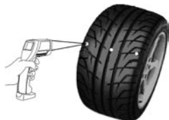
Abb. 8. Messen der Reifentemperatur
