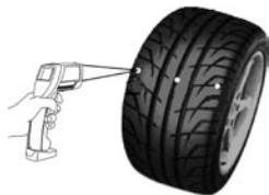
Fig. 8: Medição de temperatura de pneu
