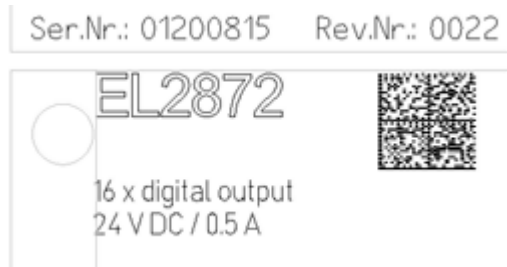
Abb. 1: EL2872 mit Revision 0022 und Seriennummer 01200815
