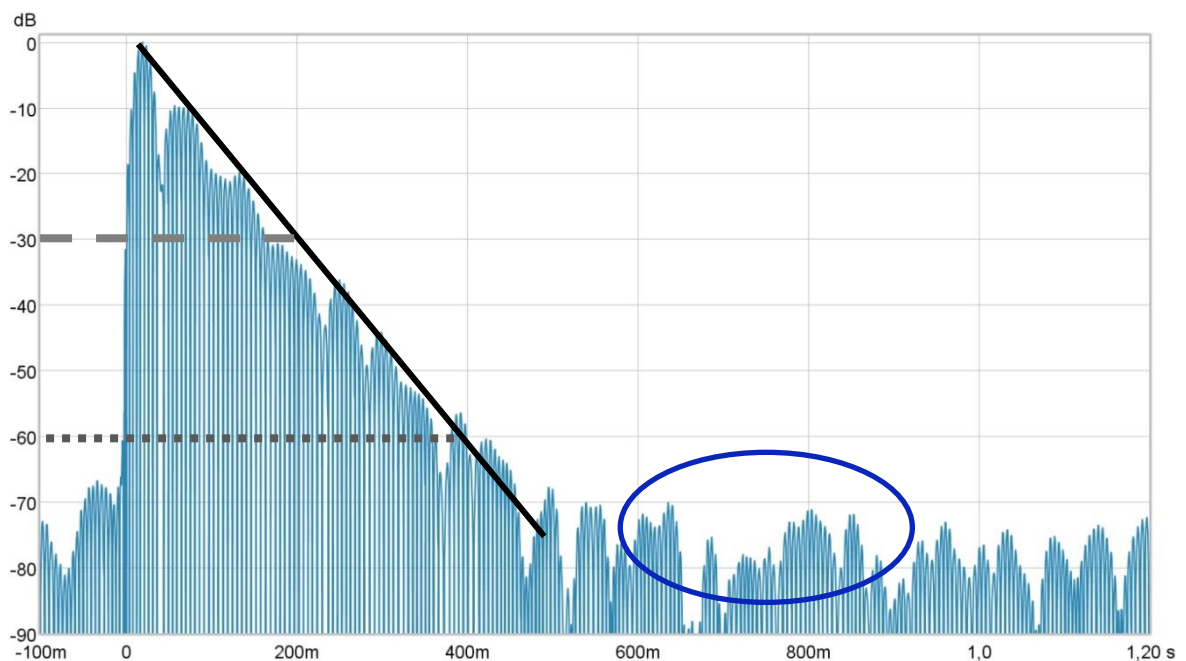
Abb. 3.13: Impulsantwort an der Hörposition zum raumakustischen Zustand 1+2+3+4 nach 100 Hz Terzbandfilterung
