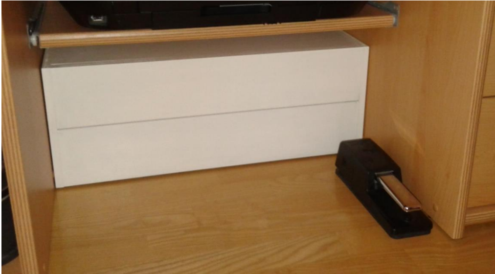
Abb. 2.11: Einzelschlitzresonator unter Studiotisch (2)
