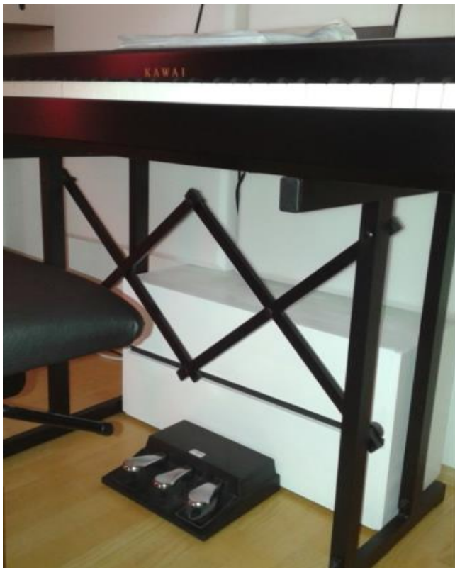
Abb. 2.12: Einzelschlitzresonator unter Keyboard (3) und hinter Esstisch (4)
