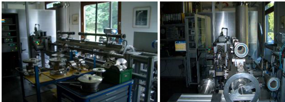
Abbildung 5.2: Wasserkalibrieranlage der Firma Krohne
