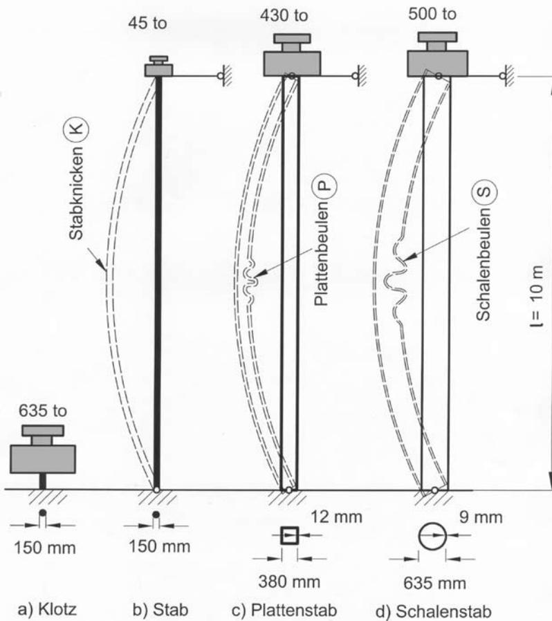
(1) Drucktragfähigkeit von Stahlbauteilen gleicher Querschnittsfläche (Baustahl S355).
