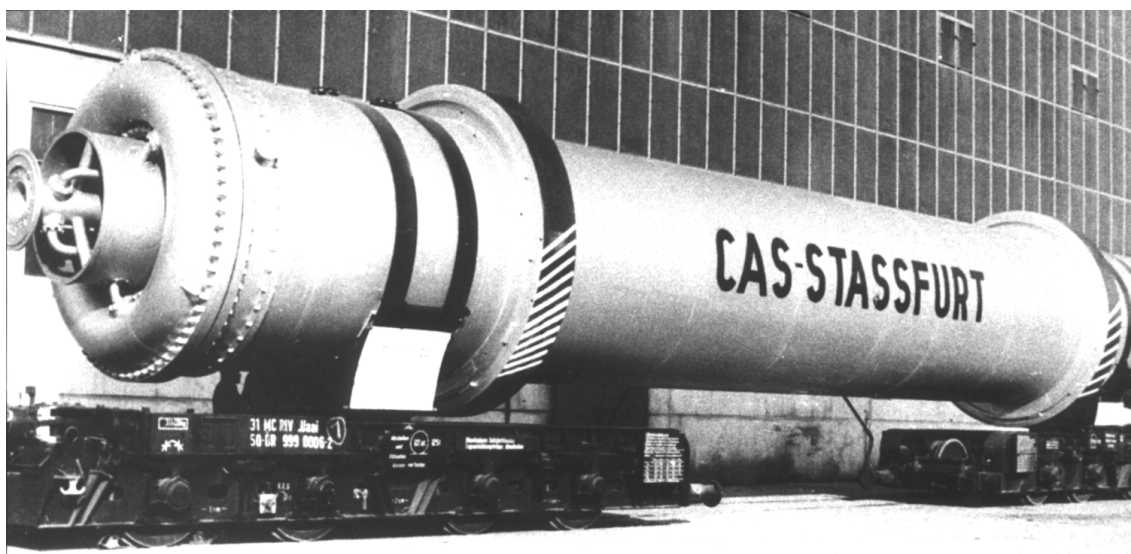
Bild 1 Dampfrohrenkalzinator 400t/d, im Betrieb komplett montiert
