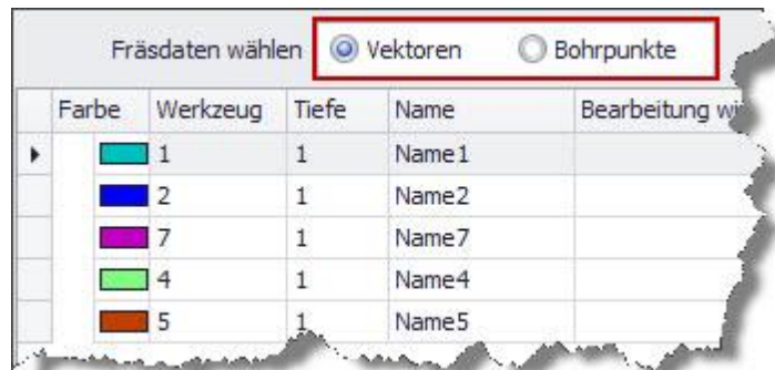
Abbildung 2: Es gibt Vektoren und Bohrpunkte, daher muss eine Datenauswahl erfolgen.
