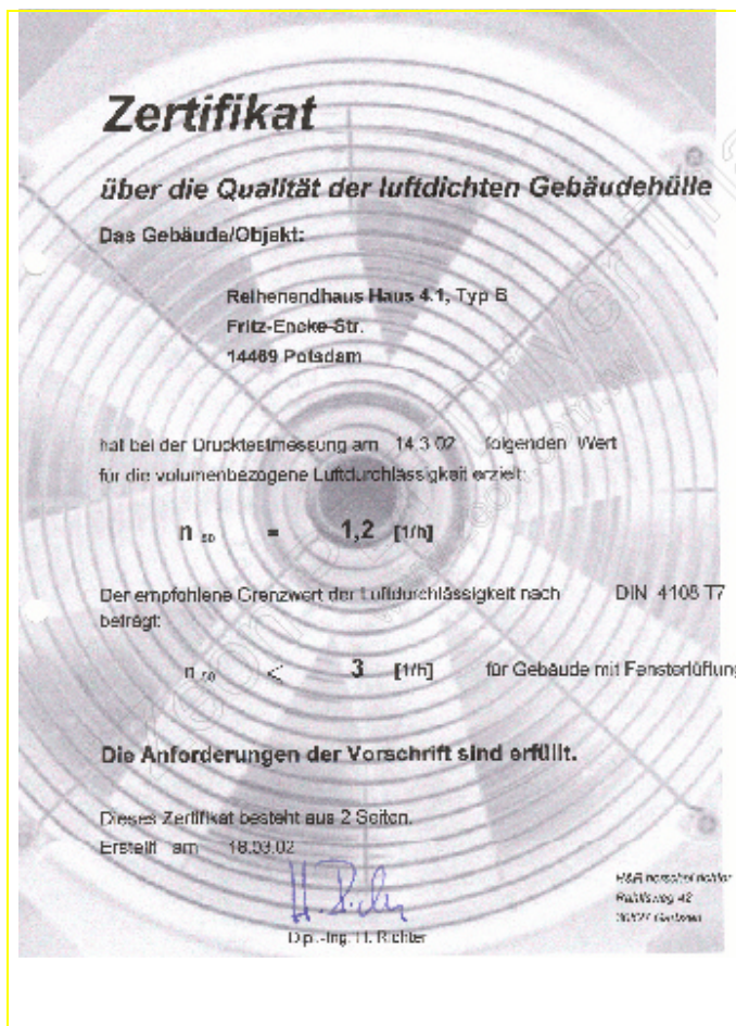
Abbildung 5-6: Protokoll der Blower-Door-Prüfung auf der Internetplattform
