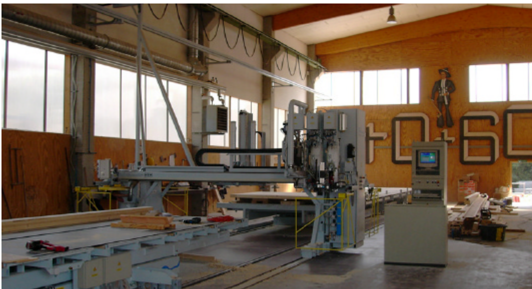
Abb 14. Bauteilbearbeitung mit einer numerisch gesteuerten Multifunktionsbrücke der Fa. Weimann und Partner, Homag-Gruppe (Quelle: ifib)
