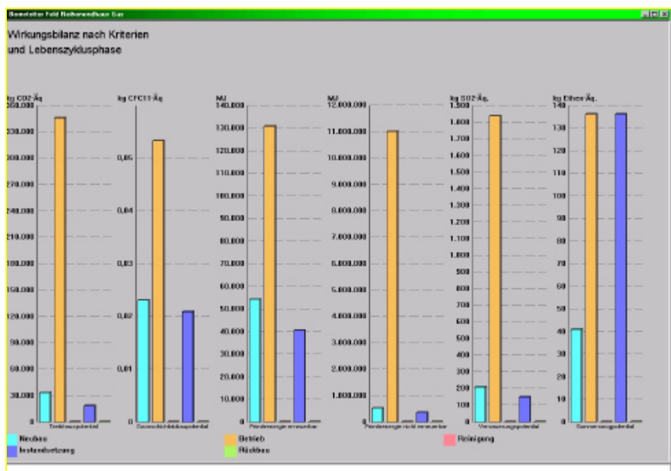
Abbildung. 8-29: Wirkungsbilanz für sechs Kate. n. Phase absolut REH mit Gasheizung absolut
