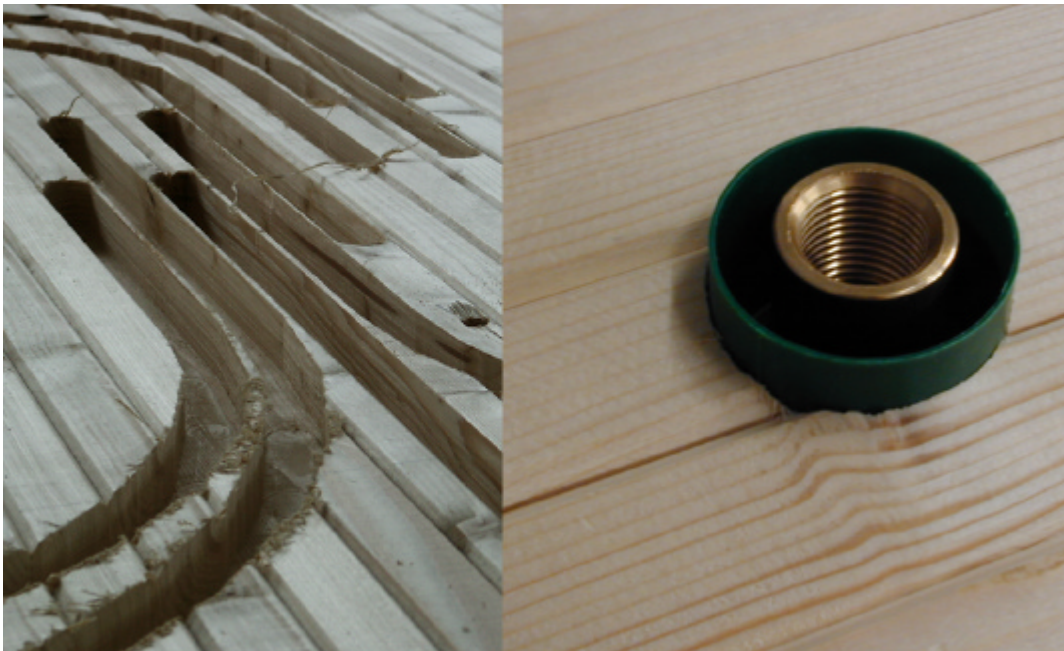
Abb 16. Qualität von Fräsungen auf der Bearbeitungs- und auf der Rückseite ; jeweils ohne Nachbearbeitung. (Quelle: ifib)
