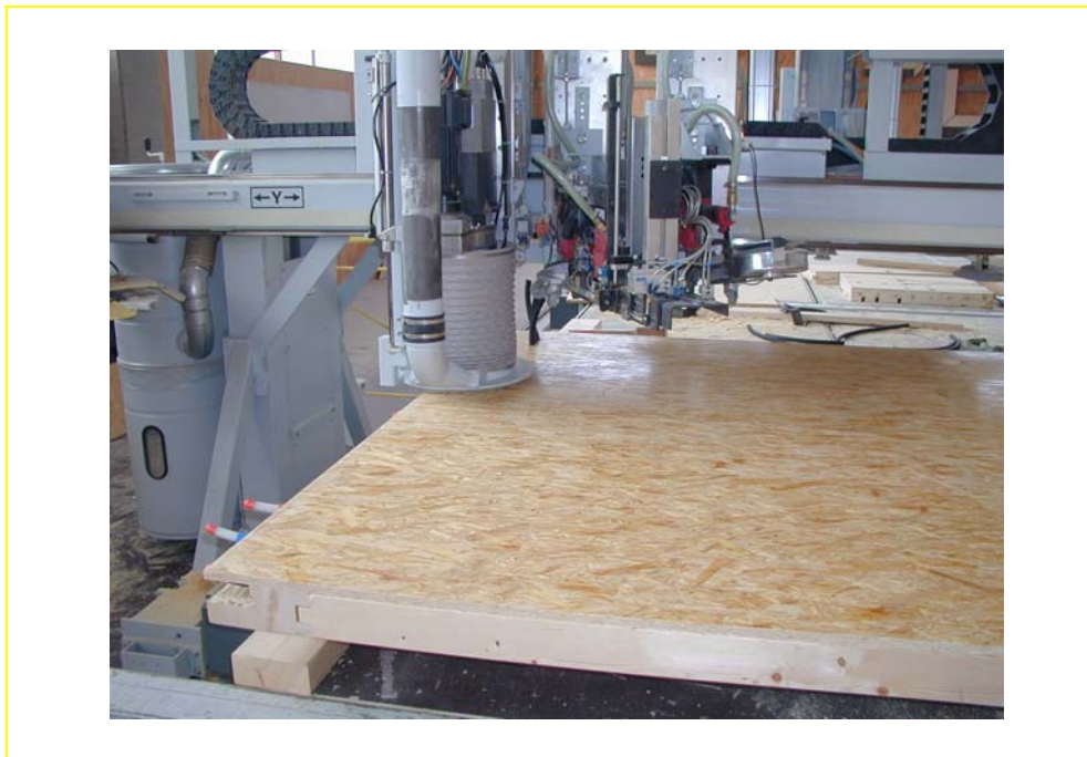
Abbildung 7-6: einfräsen von Öffnungen in bekleidetes Element
