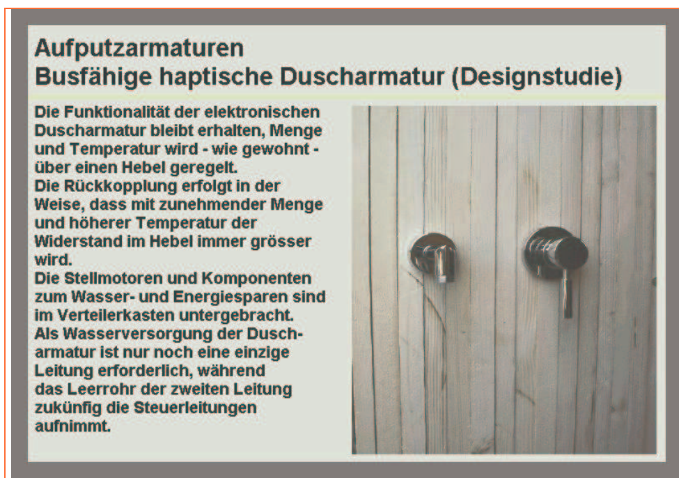
Abbildung 4-25: Design-Studie: Busfähige haptische Duscharmatur
