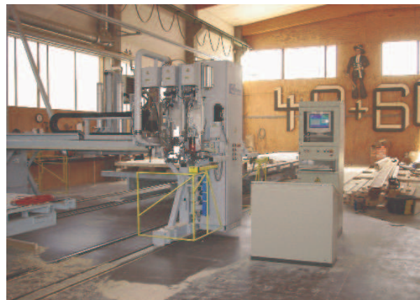
Bearbeitungszentrum mit Multifunktionsbrücke und Steuerstand
