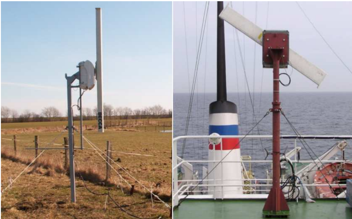
Abb. 40: Vertikal rotierende Schiffsradargeräte an Land (links, Fehmarn) und auf einem Schiff (rechts).
