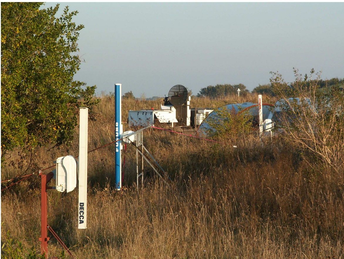
Abb. 45: Synchrone Messungen mit vertikal rotierenden Schiffsradargeräten und der Superfledermaus (im Hintergrund mit Parabolantenne).
