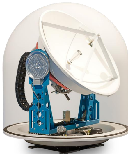
Abbildung 43: Foto der speziell für MoSaKa entwickelten High-Gain Outdoor-Unit mit angedeutetem Radom ( \varnothing 80 cm x 100 cm)
