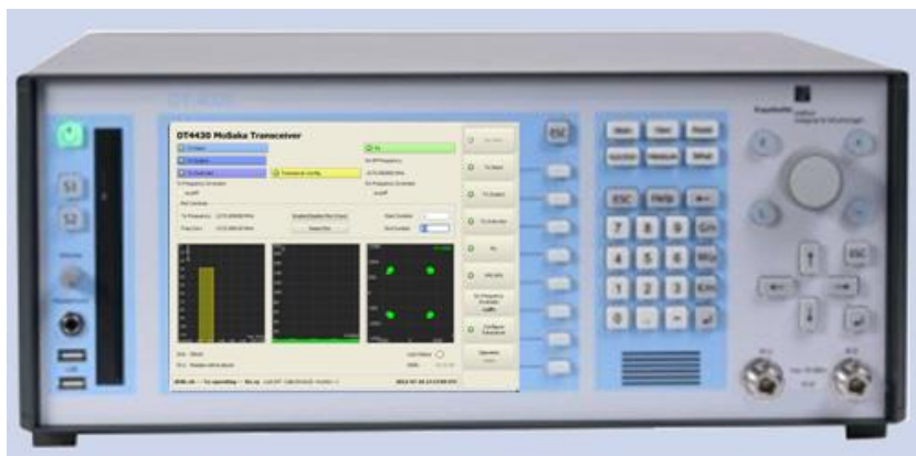
Abbildung 12: Vorderansicht des DT4430 MoSaKa Transceiver PHY
