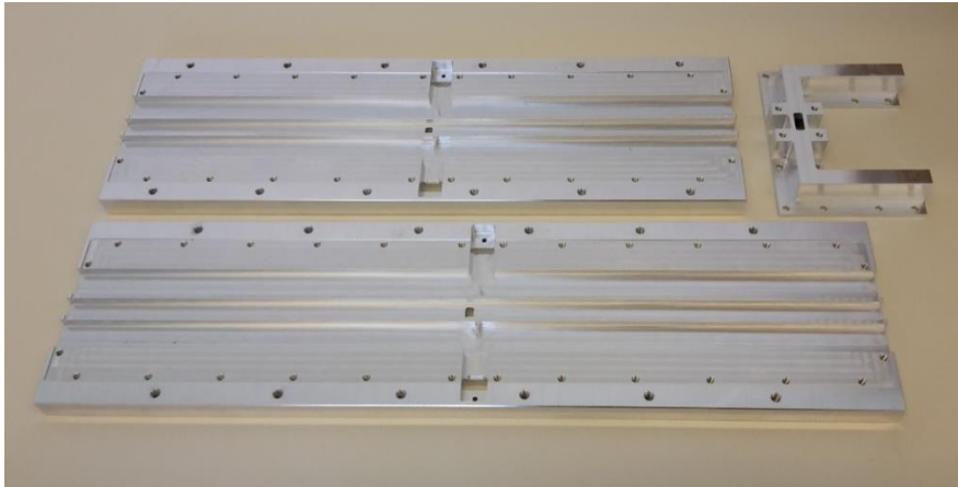
Abbildung 56: Geringe Grundmetallplatten für dualbandigen Ka-Band Antennenpaneelle mit Antennenaperturen von 70 mm x 300 mm und 70 mm x 350 mm sowie einem Hohlleiternetzwerk für 20 GHz als Zusatzbauteil für die Rückseitenmontage
