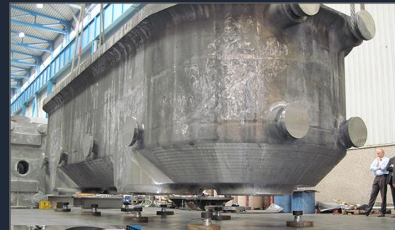
Verwiegung eines über 100t schweren Presseoberteils mit 4x MWS 30t
