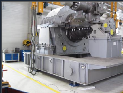
Verwiegung einer 150t schweren Turbine mit 4x MWS 50t
