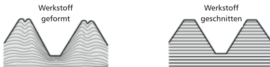
Bild 3: Faserverlauf beim Gewindeformen (links) und Gewindeschneiden (rechts)
