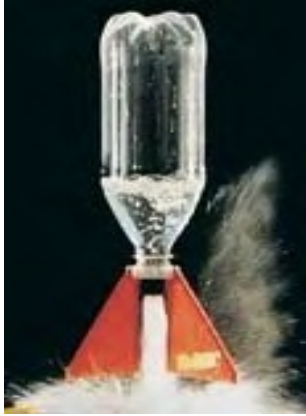
Figuur 31 – De wateruitstoot zorgt bij een waterraket voor de stuwkracht.
