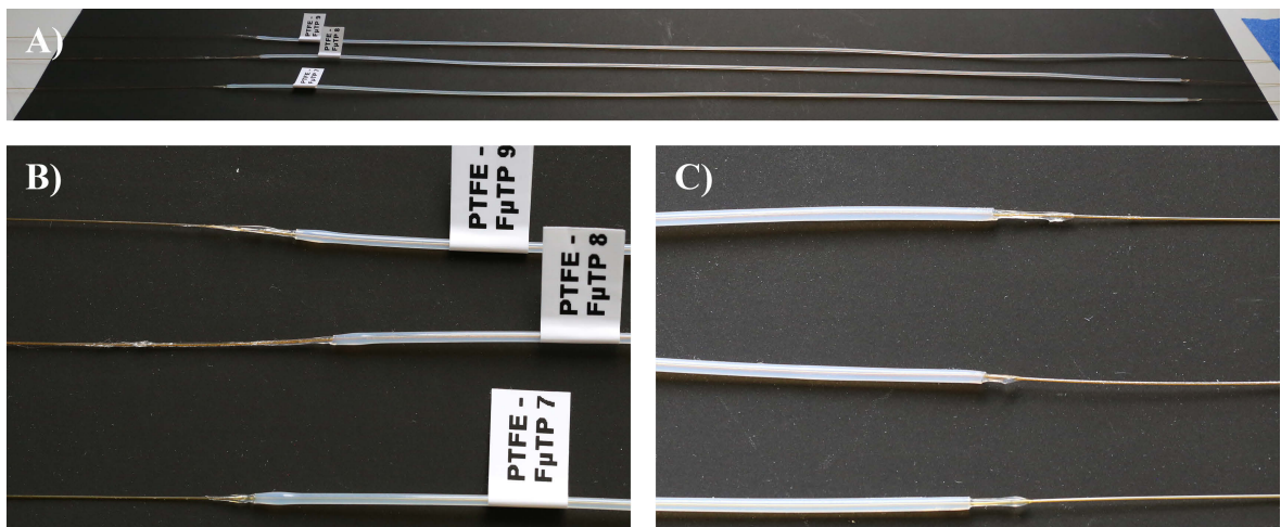
Abbildung 32: Drei auf gleiche Art erzeugte Schlaucheinheiten (A) für die robuste und langlebige Variante des F \mu TPs. Die effektiv erreichten Längen betragen 493(5) mm. Das obere Ansatzstück (B) sowie das untere Abschlussstück (C) des Zugprozesses mit geringfügig ausgetretenem FEP-Material.
