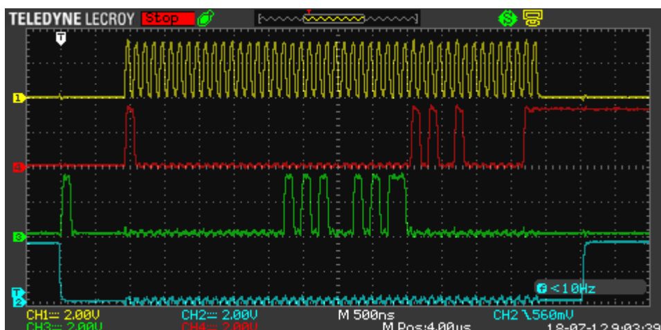
Abbildung 11: Oszilloskopaufnahme der SPI Kommunikation des Atlas Digital Amplifier mit dem STM32F746 Nucleo Development board (Quelle: eigene Aufnahme)
