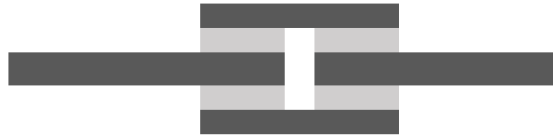
Abbildung 6.1: Doppelt gelaschter Prüfkörper nach ASTM D 3528 Typ B
