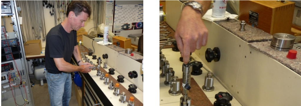
Abb. [17] Verbindung mit der Stickstoffleitung - Versorgung mit der Speisespannung
