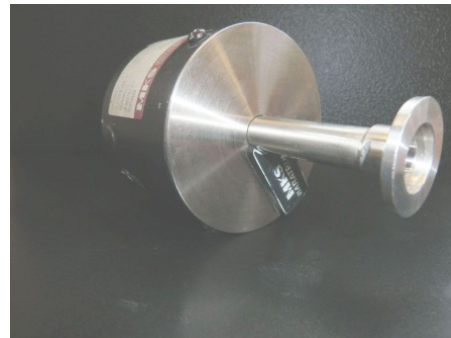
Abb. [3] Absolutdruckaufnehmer – prinzipieller Aufbau und in der Praxis
