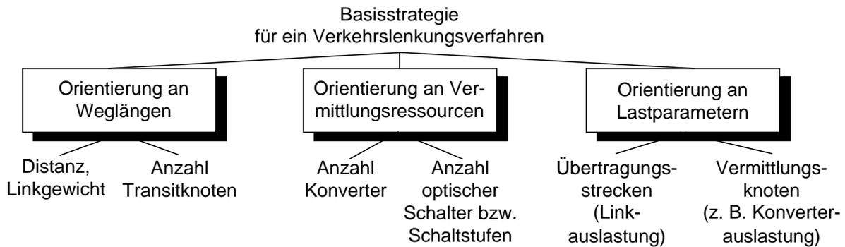
**Bild 4.7:** *Mögliche Grundausrichtungen und Parameterbeispiele für die Verkehrslenkung*
