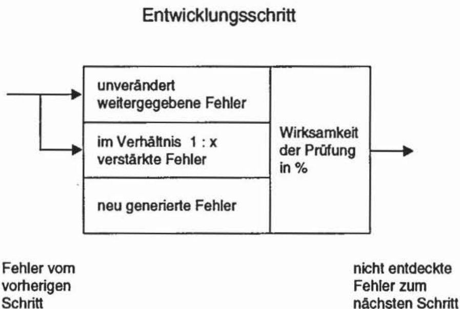
Abb. 5.2: Modell der Fehlerverstärkung nach (Pressman, 1987)
