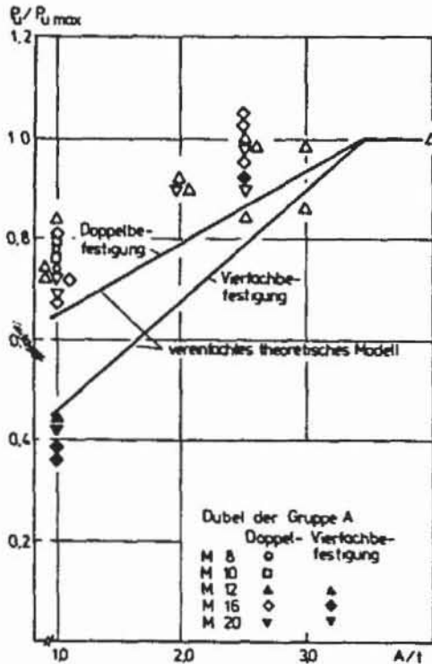
Bild 14 Einfluß des auf die Setztiefe t bezogenen Achsabstandes A bei Betonausbruch auf die Bruchlast eines Dübels einer Dübelgruppe. P_u = Bruchlast bei verringertem Achsabstand, P_{u,max} = maximale Tragkraft
