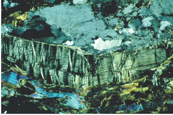
Bild 1 Gekinkter Disthen-Porphryoblast aus Grt-Stau-Ky-Glimmerschiefer ÖM.3.1c nahe Gargellen. Qz besitzt suturierte Korngrenzen, Glimmer sind ebenfalls gekinkt. 25fach, Bildbreite 5.3 mm, XPL.
