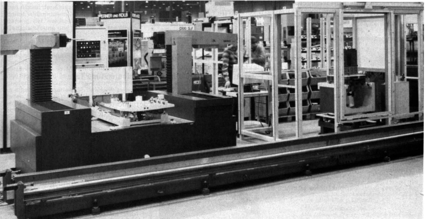
Bild 8 Messroboter in einem flexiblen Fertigungssystem (Bilder: Werner & Kolb Werkzeugmaschinen GmbH, Berlin BRD/Schweiz AG, 8021 Zürich)
