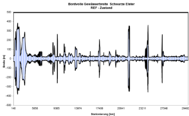
Abb. 2.1.8: Längsschnitt der Breite an der Schwarzen Elster, Referenz-Zustand
