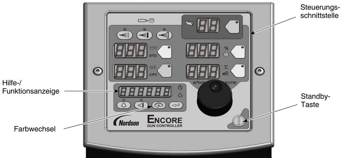
Abbildung 4-1 Systembedienelemente - mobiles System abgebildet
