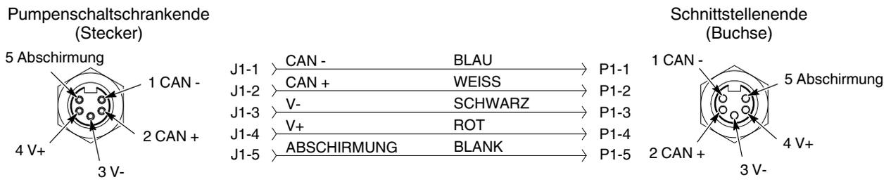
Abbildung 5-2 Verbindungskabel der Steuerung – Kontaktbelegung
