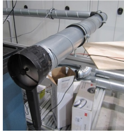
Abbildung 2.26: Komponente Belimo direkt nach Rohrbogen ohne ausreichende Einlaufstrecke mit seitlicher Anströmung
