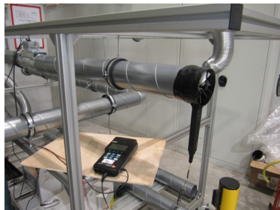
Abbildung 2.25: Komponente Pichler in geradem Rohrabschnitt mit ausreichender Ein- und Auslaufstrecke
