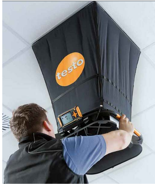
Abbildung 2.14: Messhaube zur Messung nach der Trichtermethode an großen Drallluftauslässen (Quelle: TESTO)
