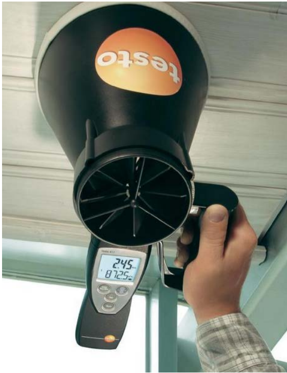
Abbildung 2.13: Messtrichter inkl. Flügelradanemometer für kleine Luftauslässe (z.B.: Tellerventile) (Quelle: TESTO)
