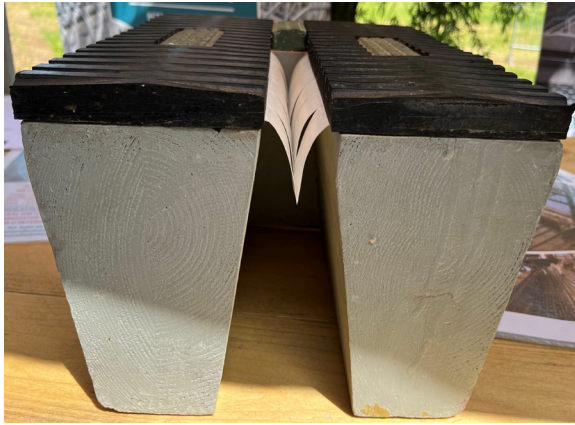
Spaltenboden mit Emissionsreduzierenden Bodenklappen (Quelle: Administration des services techniques de l'agriculture)
